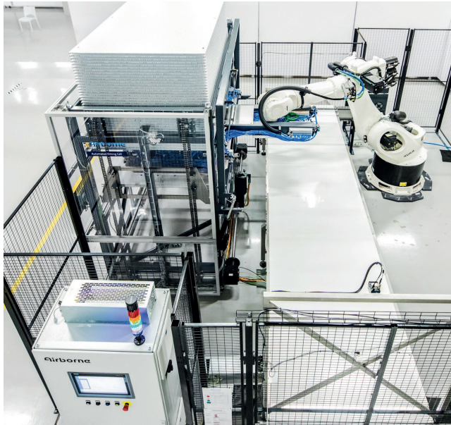
Bild 1. Die automatisierte Fertigungszelle besteht aus einer Förderschneidemaschine, einem Roboter mit angeschlossenen Effektor sowie einer Pufferstation zur Ablage der Lagen © Airborne
