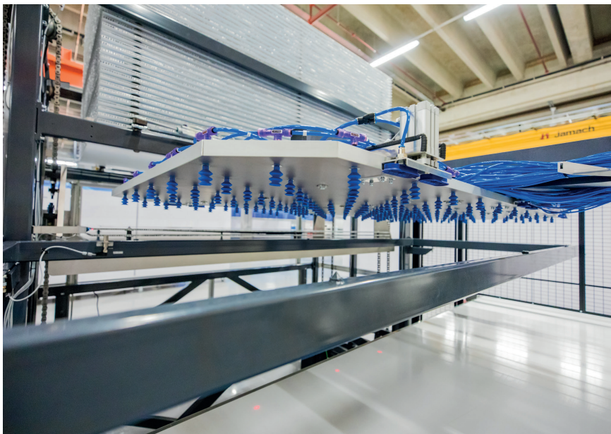
Bild 2. Der Greifer nimmt Prepregs und andere Materialien auf. Je nach Material kommen dafür etwa Saugnapf- oder Fließgreifer zum Einsatz © Airborne
