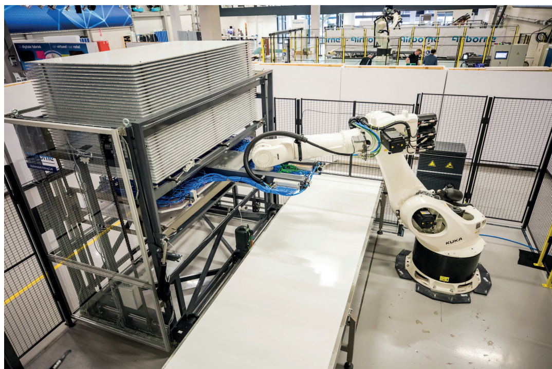
Der automatisierte Kitting-Prozess integriert die Produktionsschritte Nesting, Schneiden, Etikettierung und Kitting in eine einzelne Fertigungszelle © Airborne
